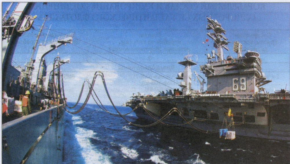
Передача грузов и топлива с УТРС Т-АОЕ 8 «Арктик» на АВМА CVN-69 «Дуайт Д. Эйзенхауэр»
